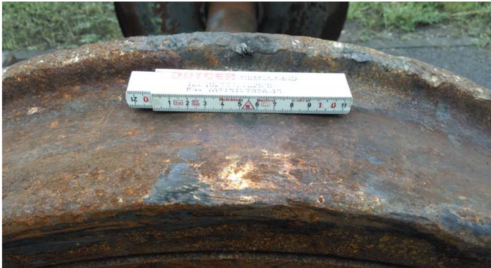
Abb. 24: Flachstelle des Radsatzes 10003405
