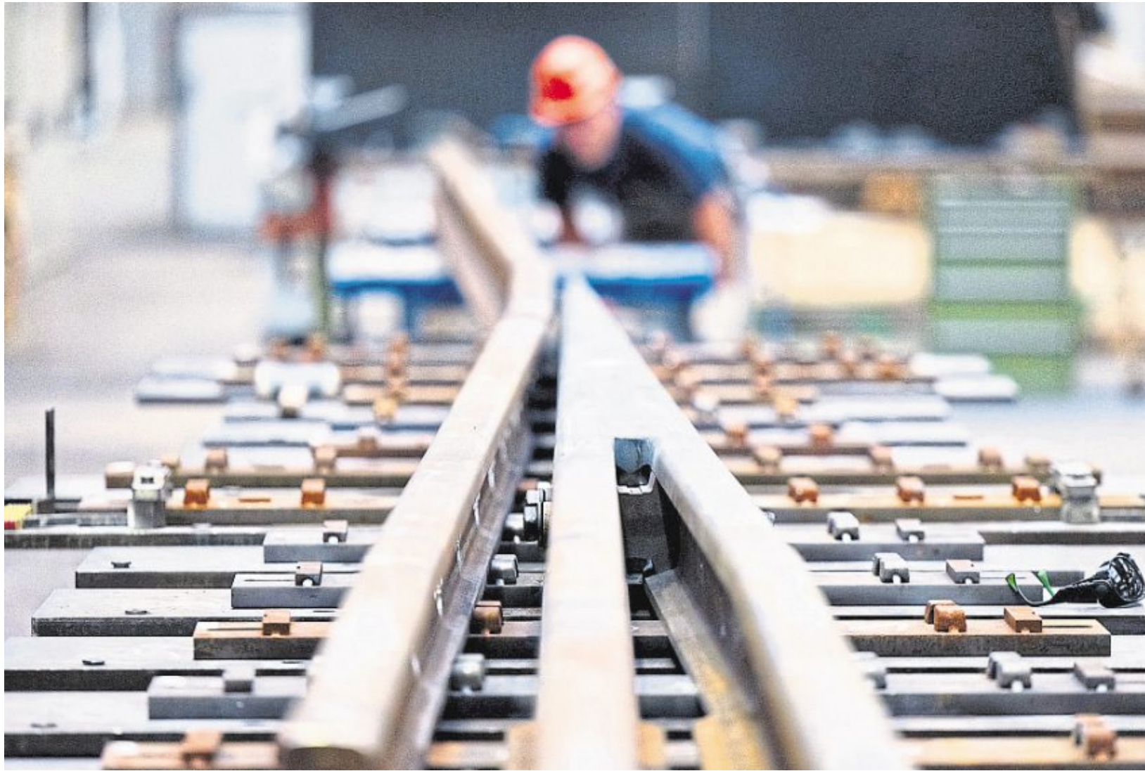
Ein Arbeiter kontrolliert im Werk Oberbaustoffe der Deutschen Bahn (DB Netze) das Herzstück einer Weiche. Allein bei der rechtsrheinischen Generalsanierung sollen laut derzeitigen Planungen 111 neue Weichen eingebaut werden.
